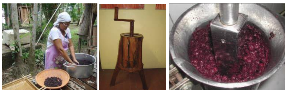
Figura 7: Da esquerda para a direita: amassadeira de açaí, despulpadora de madeira e a despulpadora metálica. Fonte: Schwob, 2012 e Rogez e Aguiar, 2012.
