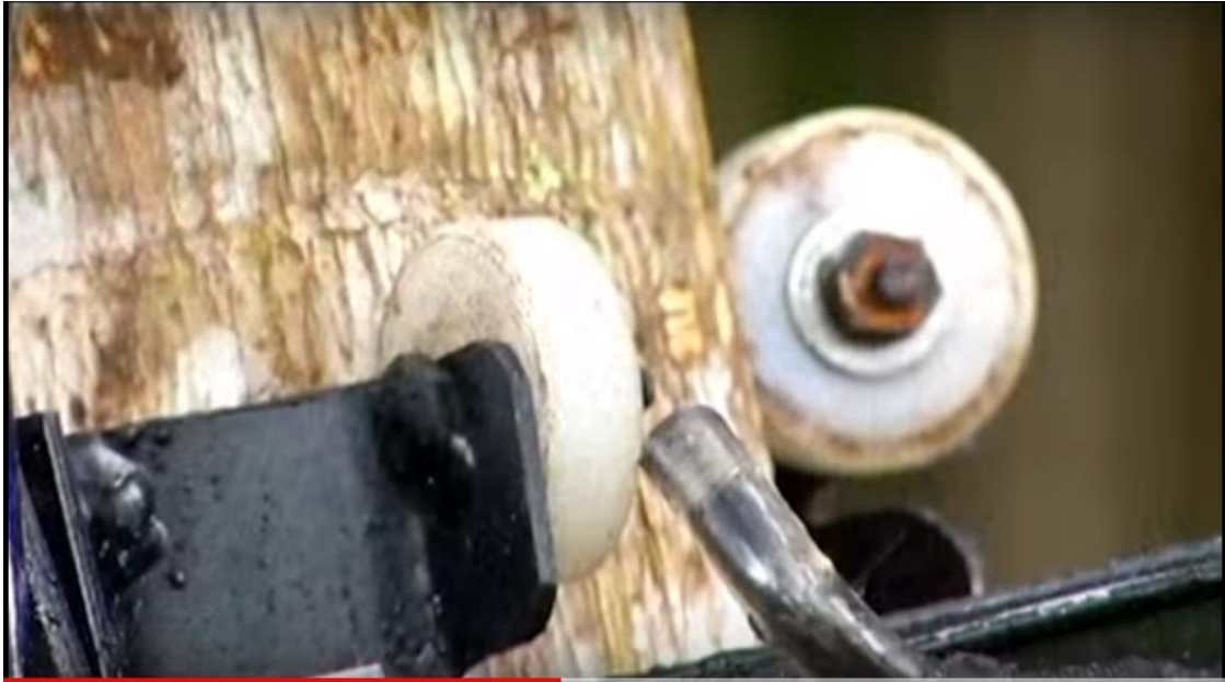
Figura 24 – A Máquina Coletora de Açai. Roldanas para fazer o rolamento da peça. Fonte: https://www.youtube.com/watch?v=cdBcmlV9SS4
